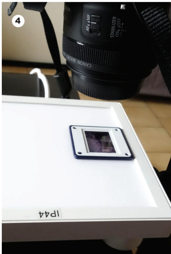
La mise au point doit se faire en manuel. Il est possible, comme indiqué au début, de vous aider de l'assistant si, bien sûr, votre appareil en est pourvu. Ainsi, à mesure que l'on tourne la bague de mise au point, les contours des éléments de l'image se
